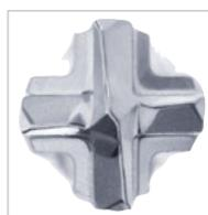
La pointe au carbure est parfaitement symétrique (4 x 90°), ainsi les quatre tranchants ont un contact régulier et proportionnelle avec le matériau et un blocage dans l'armature d'un béton est
