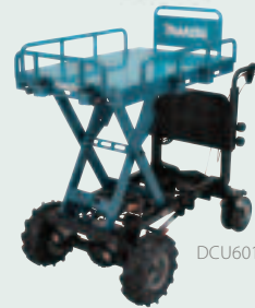
Plateau met elektrische lift
