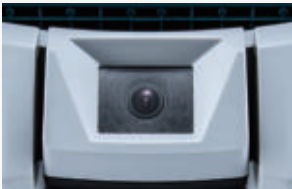
De camera maakt beelden van het plafond ter ondersteuning van de navigatie
