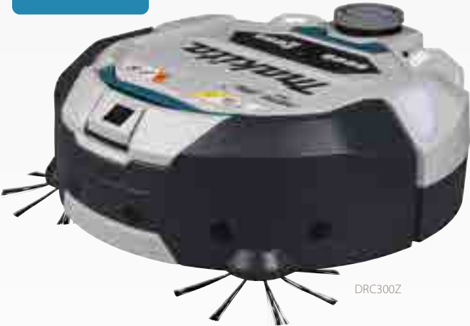
La caméra réalise des images du plafond pour faciliter la navigation.
