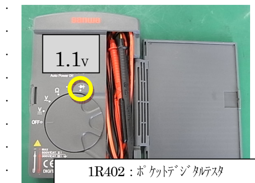
図1-1 ダイオードモード設定
