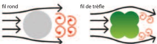
Grâce à la forme en feuille de trèfle, la résistance à l'air diminue, de sorte que le fil fonctionne plus silencieusement et économise de l'énergie.
