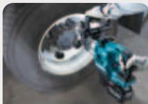
La boulonneuse TW010G est équipée d'une **enclume allongée** qui permet d'atteindre les boulons profondément encastrés.
