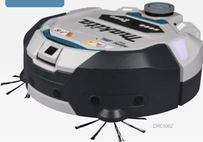
De camera maakt beelden van het plafond ter ondersteuning van de navigatie
