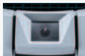
De camera maakt beelden van het plafond ter ondersteuning van de navigatie
