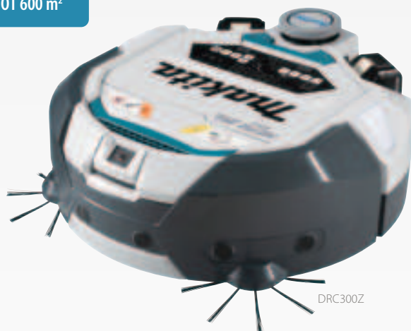
De camera maakt beelden van het plafond ter ondersteuning van de navigatie
